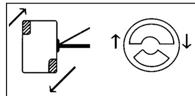
Na prática, dificilmente se encontra um destes desbalanceamentos na forma pura. Ambos são encontrados misturados, exigindo contrapesos diferentes nos lados interno e externo e em posições também diferentes de 180°.
