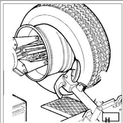
1) Se o pneu não for difícil de ser desmontado, uma vez que o cordão tenha sido afrouxado, use o disjuntor para empurrar contra o plano interno do pneu até que ambos os cordões saiam do aro (Veja a fig. H).
