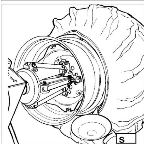
7) Verifique se a ferramenta de gancho está posicionada no lado da roda. Se não, pressione a alavanca (15, fig. D) e gire 180 °.
