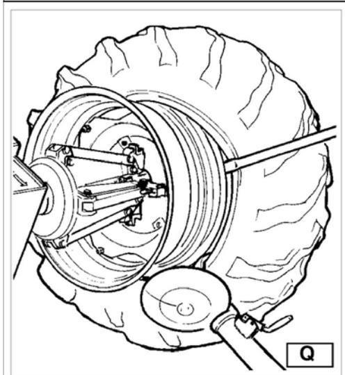
**8)** Mova o braço do porta-ferramentas para sua posição de não trabalho. Abaixar o fuso até que o pneu seja pressionado contra a plataforma. Como a plataforma é levemente deslocada para o exterior, o pneu abre um pouco e cria espaço suficiente para remover câmara de ar.
