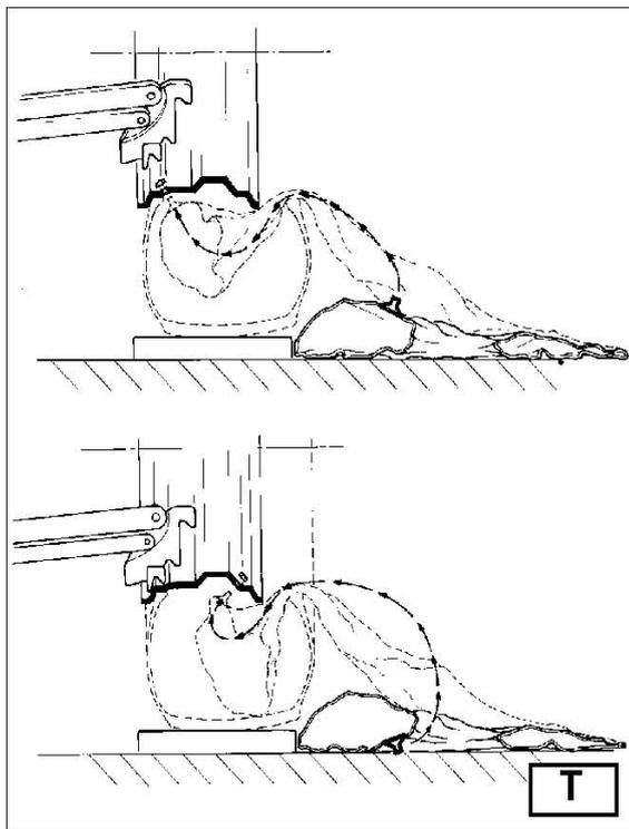
ajuste-o conforme necessário. Em seguida, gire o eixo no sentido horário até que o clipe esteja na parte inferior (6 horas). A primeira conta estará no aro. Remova o clipe.
